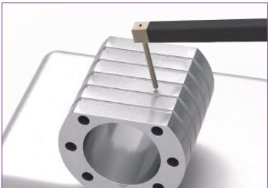
Profil et rugosité de la pièce
