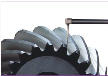
Ra de la surface de dent d'engrenage
