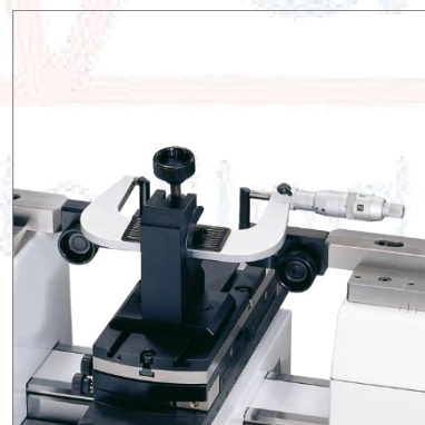
Etalonnage de micromètres extérieurs (TA-SU-313, HPA-1, TULM14)
