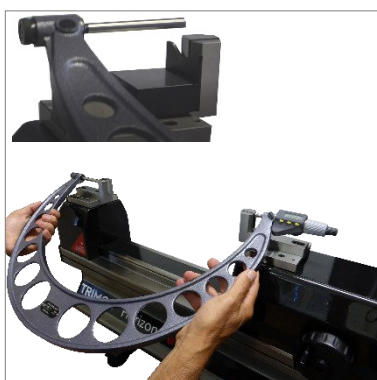
Contrôle manuel de grands micromètres (TEL5, TEL11)
