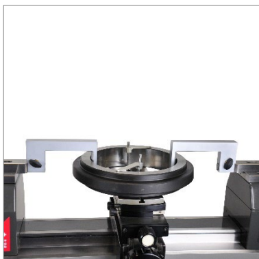
Vérification des calibres-cylindres (TA-SU-313, TA-MI-370, TA-SU-304)
