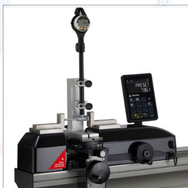
Etalonnage sur support de vérificateurs d'alésages à 2 points (TA-SU-313, TA-SU-318, TEL5)
