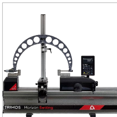
Vérification d'un micromètre externe monté sur support (TA-SU-313, LABC20.1/SP02, TEL5)
