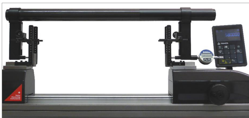
Etalonnage d'une jauge de grande dimension
