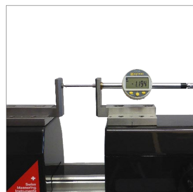
Vérification de comparateurs (TEL5CN)
