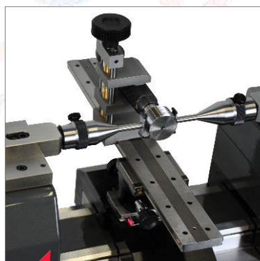
Vérification des calibres-fils(max. M100/ø 4", length 280 mm/11") (TEL6, 3P/ 0.17-3.2/ S6.5, LABC15)
