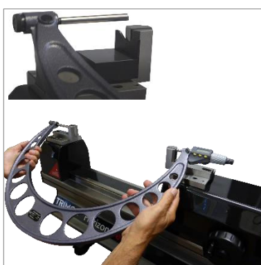
Contrôle manuel de grands micromètres (TEL5)(TEL11)
