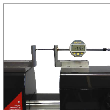
Vérification de comparateurs (TEL5CN)
