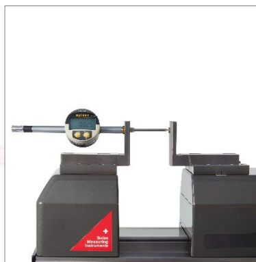
Vérification des comparateurs et indicateurs à cadran (TEL 5CN)
