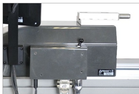
Deux dispositifs de verrouillage pour maintenir le chariot
