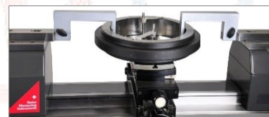
Vérification des calibres-cylindres à partir de 12 mm
