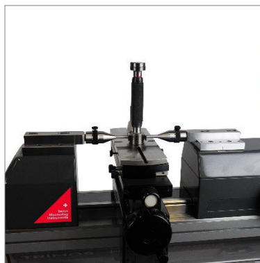
Vérification des calibres-fils (à partir de M100) (TA-SU-313, TEL6, 3P/0.17-3.2/S6.5)
