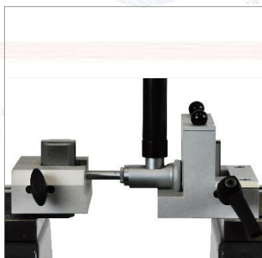
Réglage des calibres à alésage à deux points(TA-SU-301, TEL5 )
