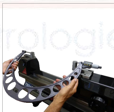
Vérification manuelle d'un micromètre externe (TEL5, TEL 11)
