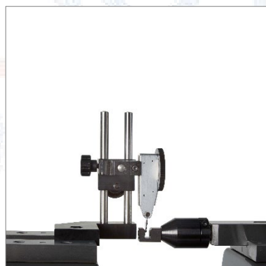
Vérification des indicateurs de contrôle(TULM 15.1)
