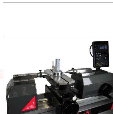
Vérification des calibres-fils (diamètre supérieur à 100 mm) (TEL6, TA-SU-313, TULM6/L0.5, TA-SU-304)
