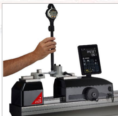
Réglage manuel des calibres à alésage à deux points (TA-SU-301, TEL5)
