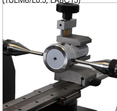
Vérification des calibres-fils et des calibres-jauges (max. \varnothing 100mm/4'' , length 280mm/11'') (TULM6/L0.5, LABC15)
